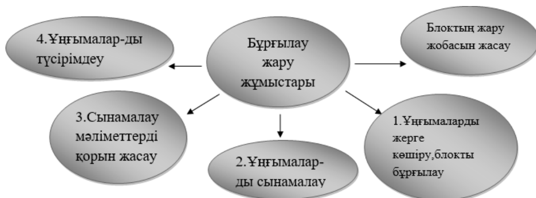
Сурет 10 - Карьердегі бұрғылау-жару жұмыстарын маркшейдерлік қамтамасыз етудің блок схемасы
